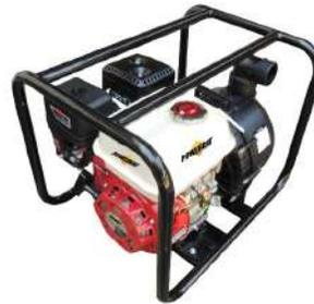
Motor 4 tiempos OHV, 75 hp, 209 cc, succión/descarga 2"x2", succión máxima 8 metros, altura máxima 30 metros, caudal máximo 36m<sup>3</sup>/hr, bomba para químicos de propileno, autocebante, RPM 3600.
