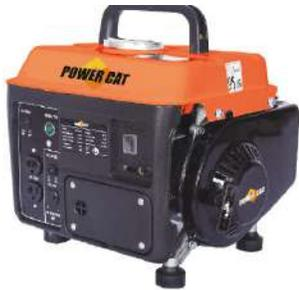
motor 2 tiempos, arranque manual, 2 hp, 63 cc, 127 v, 60 hz, 800w, peso 16 kg, capacidad de combustible 4 litros, salida DC 12 V - 8,3 A, no incluye sensor de aceite, incluye sistema AVR, 4,5 horas continuas de operación, interruptor de sobrecarga incluido, voltímetro incluido.
