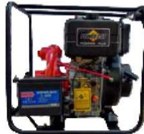
Motor diesel 4 tiempos, 18 hp, 531 cc, succión/descarga 3"x3", succión máxima 7 metros, altura máxima 145 metros, caudal máximo 45 m<sup>3</sup>/hr, electrificar, batería incluida, peso 96 kg.
