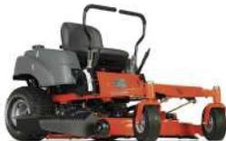
Motor Kohler/B&S, 2 cilindros v-twin, 23 hp/725cc, diámetro de corte 46", transmisión hidrostática, tanque de combustible 3,5 Gal., asiento ajustable, (bolsa recolectora opcional) (sin batería).
