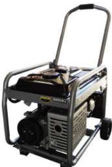
6 Kw, motor 4 tiempos, OHV, 15 hp, 420 cc, generador 6500 w continuos, 7500 w pico, 105 kg, 120-240 v. Capacidad del tanque 25 litros. 8 horas de trabajo continuo, arranque eléctrico y manual, sistema de regulación de voltaje AVR, peso 93 kg.
