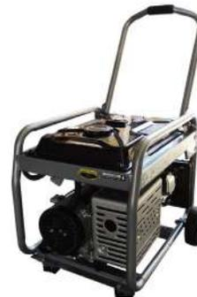
5 Kw, motor 4 tiempos OHV, 420 cc, generador 5500 w continuos, 6500w pico, 85 kg, 120-240 v. Capacidad del tanque 25 litros, 7 horas de trabajo continuo, arranque eléctrico y manual, sistema de regulación de voltaje AVR, peso 89 kg.
