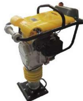
Motor 4 tiempos, 5,5 hp, fuerza al impacto 10 Kn, ritmo de percusión 450-650 rpm, golpe de salto 40-65 mm/45-650 rmp, avance de velocidad 10-13 m, tamaño de placa inferior 310x300 mm, peso 76 kg, 3600 RPM, sensor de aceite y fuelle.
