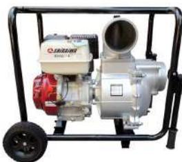
Motor Shiraiwa 4 tiempos OHV, 15 hp, 420 cc, succión/descarga 6"x6", succión máxima 8 metros, altura máxima 30 metros, caudal máximo 150m<sup>3</sup>/hr, peso 75 kg.
