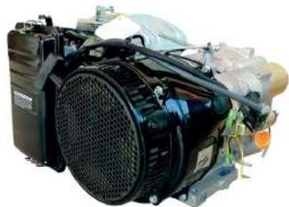
Motor 4 tiempos potencia de 15hp, cilindrada 420 cc, 3600 rpm, arranque manual, alerta de aceite, eje de 25.4 mm. (Flecha horizontal cónica para generador pwc 6500-7500).
