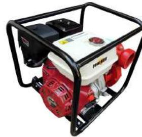
Motor 4 tiempos OHV, 15 hp, 430 cc, succión/descarga 3"x3", succión máxima 8 metros, altura máxima 85 metros, caudal máximo 40.4m<sup>3</sup>/hr, impulsor de caracol, RPM 3600.
