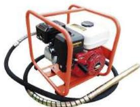
**Vibrador.** Motor 4 tiempos, Powercat, 38 mm de chicote de 6 y 4 mts, sistema de péndulo, motor de 6.5 Hp, 3600 rpm, sensor de aceite, doble placa para golpe.
