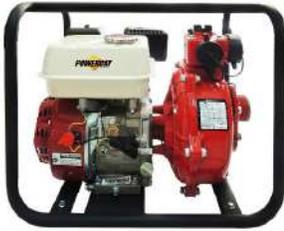
Motor 4 tiempos OHV, 75 hp, 270 cc, succión/descarga 2"x2", succión máxima 8 metros, altura máxima 55 metros, caudal máximo 50m<sup>3</sup>/hr, RPM 3600.
