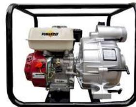
Motor 4 tiempos OHV, 75 hp, 270 cc, succión/descarga 3"x3", succión máxima 8 metros, altura máxima 30 metros, caudal máximo 60m<sup>3</sup>/hr, autocebante y tragasólidos, RPM 3600.
