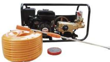
Base tipo estructura, manguera de 50/100 metros, 800/1200 rpm, succión de 22 metros, potencia de 6.5 Hp, sensor de aceite, pistones de cerámica, motor Powercat.
