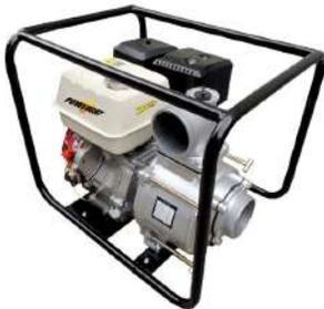
Motor 4 tiempos OHV, 15 hp, 430 cc, succión/descarga 4"x4", succión máxima 8 metros, altura máxima 30 metros, caudal máximo 96m<sup>3</sup>/hr, RPM 3600.
