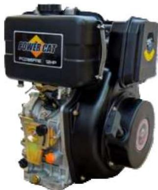
Motor Diesel 4 tiempos, 12 hp, 418 cc, 3600 rpm, arranque eléctrico, flecha 24.4 mm, peso 51 kg.
