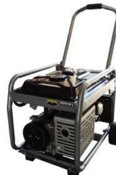
7 Kw, motor 4 tiempos OHV, 17 hp, 439 cc, generador 7500 w continuos, 9500 w pico, 105 kg, 120-240 v. Capacidad del tanque 25 litros, 7 horas de trabajo continuo, arranque eléctrico y manual, sistema de regulación de voltaje AVR, peso 99 kg.
