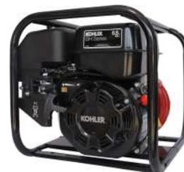
Motor kohler sh270 4 tiempos de 6,5 hp, ohv, succión/descarga 2"x2", succión máxima de 7 mts, altura máxima 55 mts, caudal máximo 20 m<sup>3</sup>/h.
