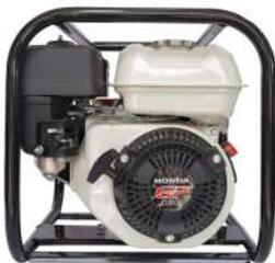
Motor honda gp160 4 tiempos de 5,5 hp, ohv, succión/descarga 2"x2", succión máxima de 7 mts, altura máxima 55 mts, caudal máximo 20 m<sup>3</sup>/h.
