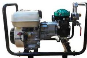
Motor Shiraiwa 6.5 HP 4 tiempos OHV, cigüeñal directo, presión 600 psi/40 bar, flujo de presión: 35 lts/minuto, bomba con 2 diafragmas y 2 cilindros, 50 mts de manguera 13.5 Mm, pistola uso profesional.
